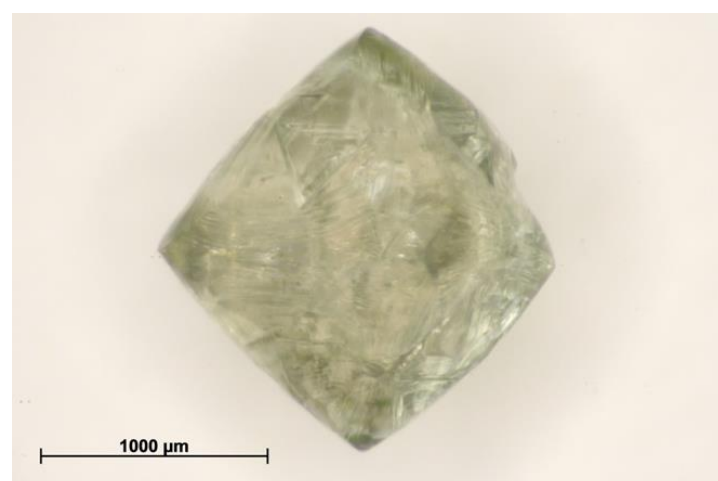
Рис. 2. Образец 1784-34-7, трубка Архангельская. Пример кристалла, принадлежащего к I разновидности по классификации Ю.Л. Орлова.
