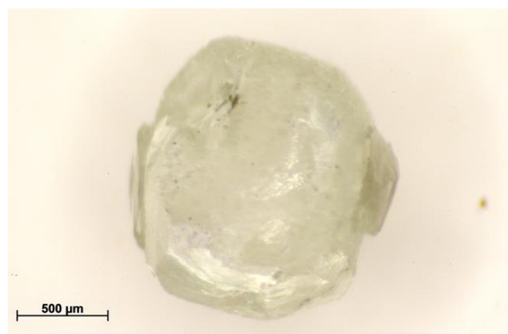
Рис. 4. Образец 1784-33-5, трубка Архангельская. Пример кристалла, принадлежащего к IV разновидности по классификации Ю.Л. Орлова, алмаз «в оболочке».
